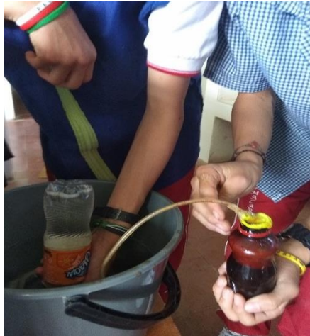
Figura 4-20: Muestra fotográfica del montaje sobre la recolección del gas de una gaseosa.
