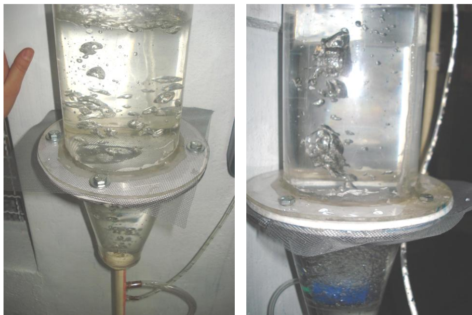
Foto 6. 12. Izquierda y derecha. Ensayo de fluidización con malla de fibra de vidrio.
