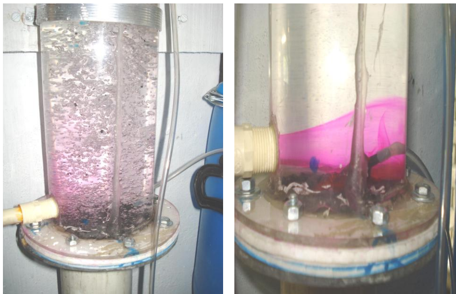
Foto 6. 14. Izquierda. Tamaño de burbuja. Derecha. Alimentación lateral con difusor de caucho perforado.
