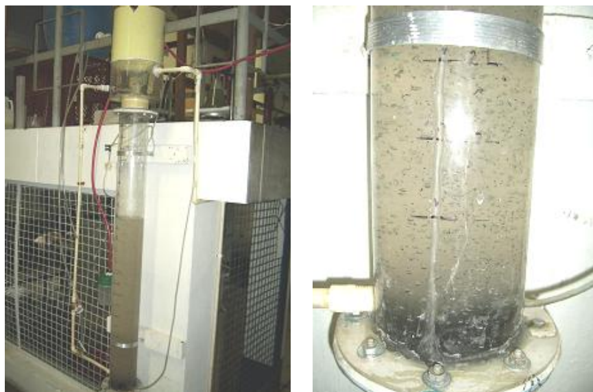
Foto 6. 19. RLF en prueba en discontinuo para formación de biopelícula.
