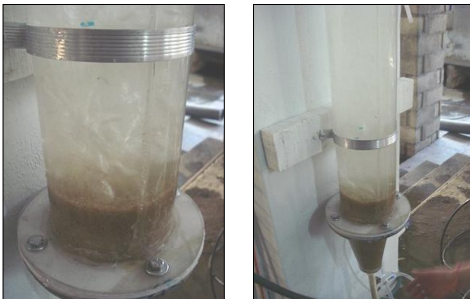
Foto 6. 11. Ensayo de fluidización con arena comercial.
