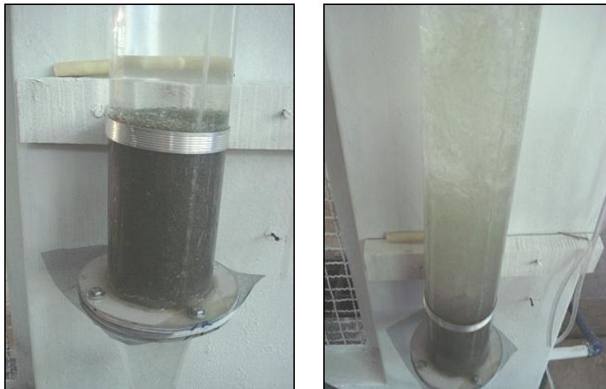
Foto 6. 10. Ensayo de fluidización con vidrio residual en polietileno cristal
