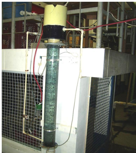
Foto 6. 15. Configuración final del bioreactor piloto trifásico de lecho fluidizado.
