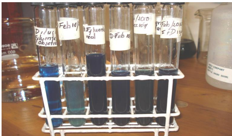
Foto 6. 1. Pruebas de laboratorio para formulación de agua residual industrial sintética.
