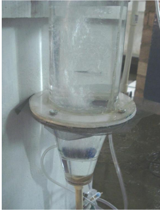
Foto 6. 13. Ensayo de fluidización con difusor cerámico.
