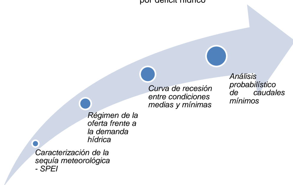
Figura 52. Esquema de la metodología planteada para estimar la amenaza por déficit hídrico
