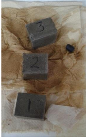
a) Cubos para compresión
