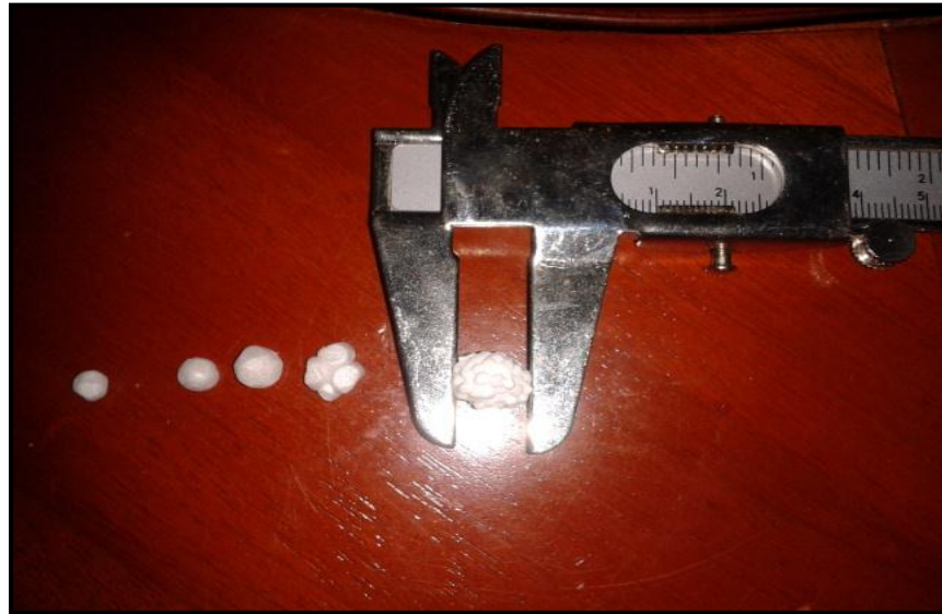
Figura 3.1: Tamaño de la granza de EPS después de molido. Fuente: Autora
