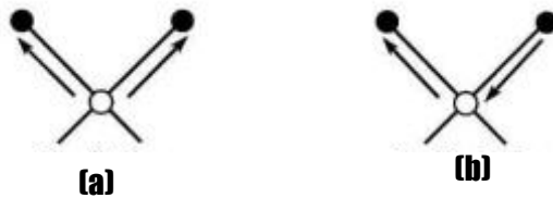
Figura 1.21: Vibraciones de tensión “stretching” (a) Simétrica (b) Antisimétrica. Fuente:[83]
