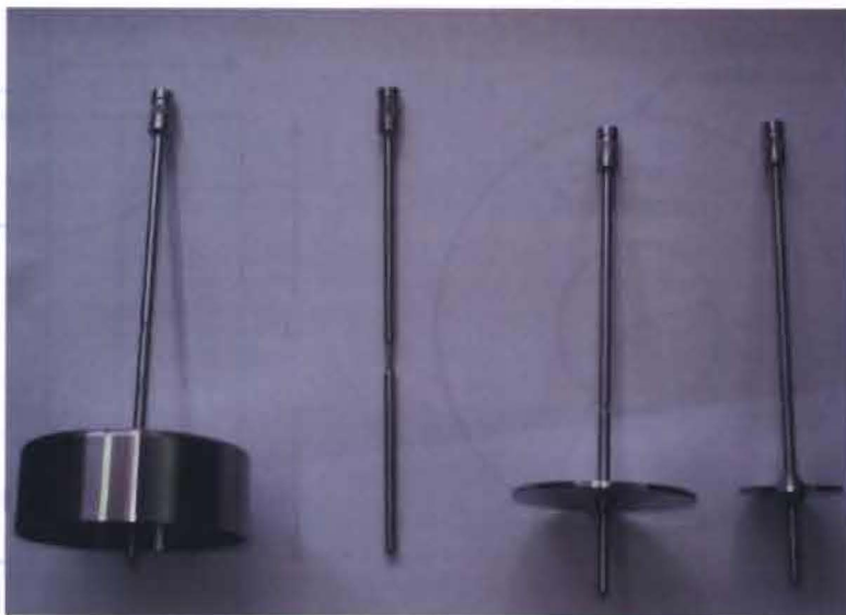
Figura 6. Dispositivos de eje rotacional "spindles".
