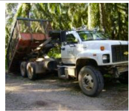
Figura 17. Descargue de caja contenedora
