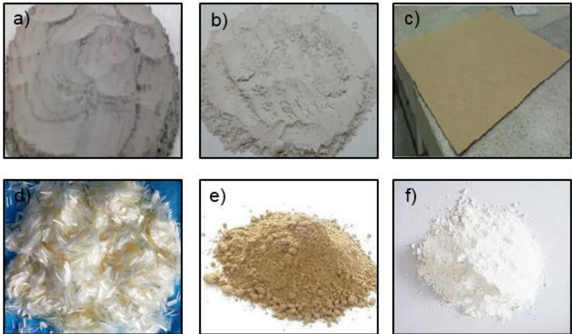
Figura 2- 2: Materia prima utilizada para la elaboración de las placas de fibrocemento: a) cemento, b) nanosílice, c) celulosa, d) fibra PVA, e) bentonita y f) carbonato.
