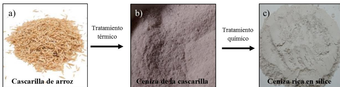
Figura 2- 1: Transformación de la cascarilla de arroz en ceniza con alto contenido de sílice después del tratamiento térmico y lixiviación ácida, a) cascarilla de arroz, b) ceniza de la cascarilla de arroz, c) ceniza blanca con alto contenido de sílice.
