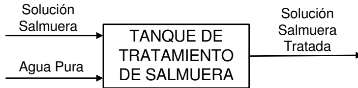
Figura 3.2: Diagrama de Bloques (DB) del tanque de tratamiento de Salmuera del ejemplo.
