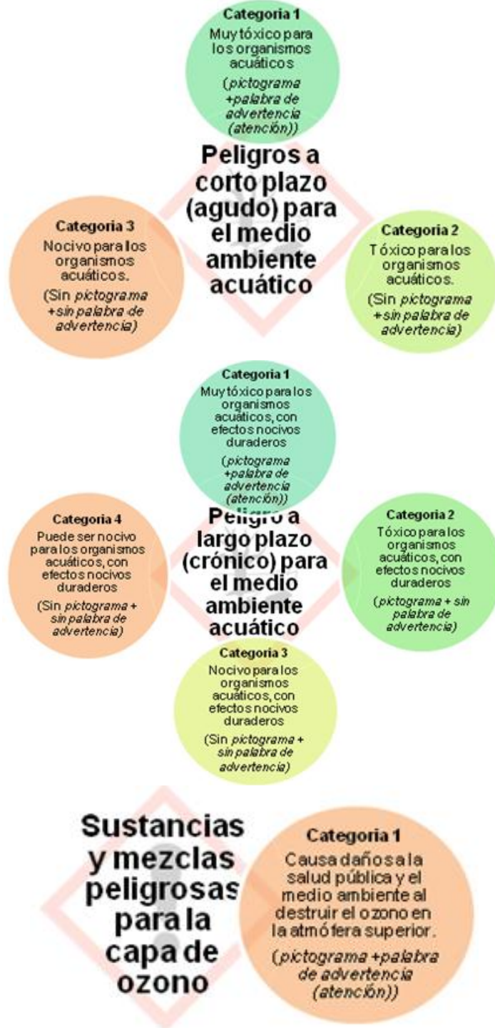
Figura 4: Peligro para el medio ambiente acorde con el SGA
