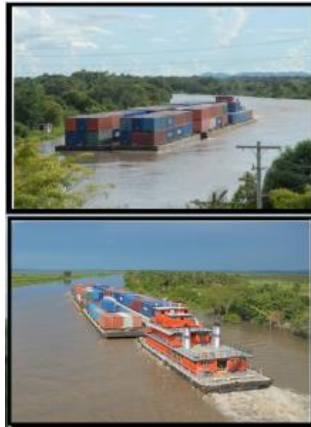
Imagen 12- Cada convoy de estos, moviliza hasta 250 TEU, equivalentes a 5000 ton, equivalentes al 50% de la carga típica de un tren en el Cerrejón. Imagen en https://godues.wordpress.com
