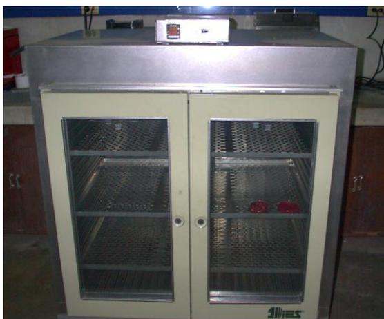
**Figura 1.** Deshidratador de bandejas.
