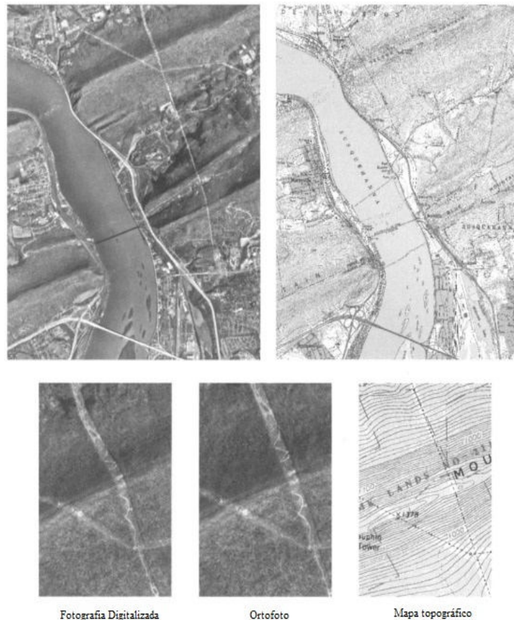
Figura 2-1.: Resultado de la ortorrectificación de una fotografía análoga comparada con un mapa topográfico. Fuente: [Schowengerdt, 2007]
