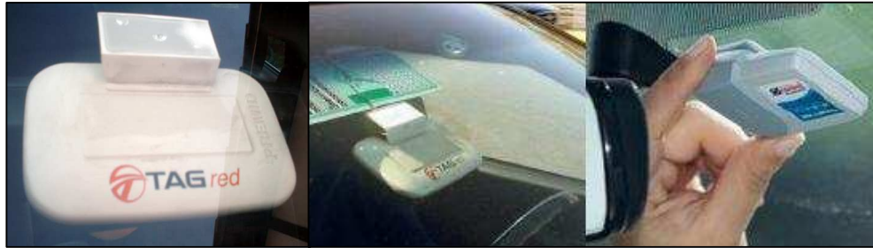
Figura 9. Un Tag chileno (dispositivo de cobro) adosado al parabrisas de un automóvil.
