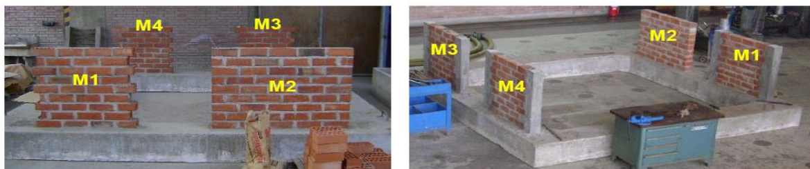
Imagen 3.4.1-3. Muretes estudiados sobre vigas de concreto. Imagen 3.4.1-4. Muretes estudiados
