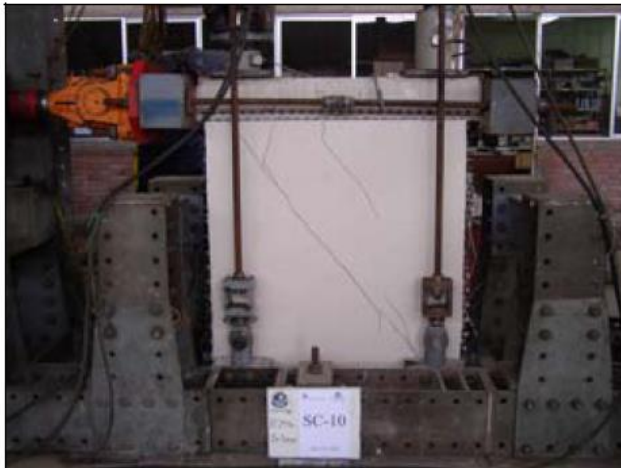
Imagen 3.2.2-3. Ensayo de paneles a corte-compresión; Imagen 3.2.2-4. Ensayo de paneles a flexión. Fuente: TORREALVA, D. Refuerzo de muros y tabiques de albañilería con mallas de polímero. Pontificia Universidad Católica del Perú . [En línea] 2007. Disponible en web: < http://blog.pucp.edu.pe/media/688/20071017-Torrealva-Polimero.pdf >.
