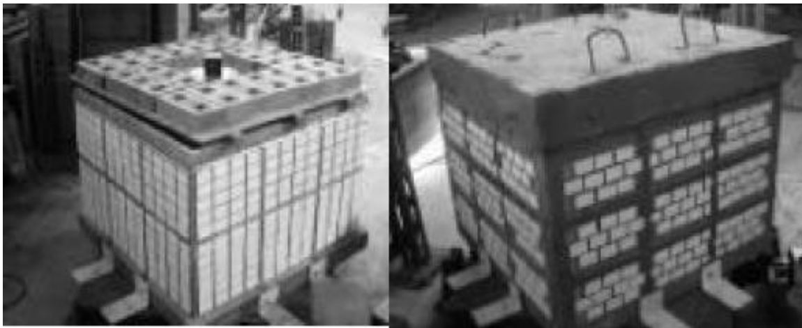
Imágenes 6.1.1, y 6.1.2., Modelos a escala 1:5 contruidos con ladrillo tolete y con bloque de arcilla hueco. Fuente: Comportamiento sísmico de muros de mampostería con refuerzo exterior estudiados en modelos a escala en la mesa vibratoria [41]
