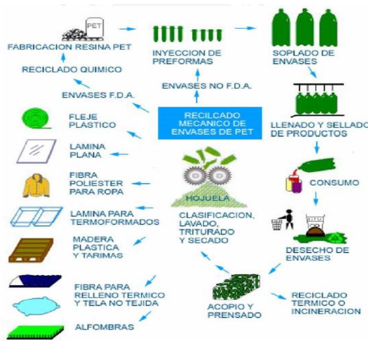
Figura 3.1.5-1 ciclo de vida de un recipiente de PET Fuente: MASÍAS, L. y ÍTALO, D. Diseño de un molde para la fabricación de probetas de materiales compuestos de matriz plástica y refuerzos de fibras naturales mediante compresión térmica PUCP [Tesis de grado]. Lima: Pontificia Universidad Católica de Perú, 2011.
