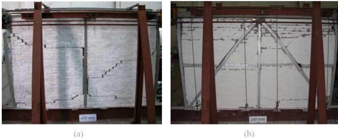
Imagen 3.3.2-1. Estado de murete de prueba (a), luego de los ensayos cíclicos; Imagen 3.3.2-2. Estado de murete de prueba (b), luego de los ensayos cíclicos. Fuente: PAIKARA, S y RAI, D. Confining Masonry Using Pre-Cast Rc Element For Enhanced Earthquake Resistance . San Francisco, California: s.n., 2006. Proceedings of the 8th U.S. National Conference on Earthquake Engineering. Paper No. 1177.
