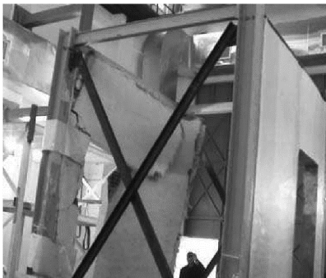
Collasso della parete NON rinforzata
