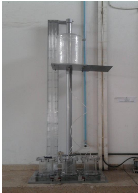
Figura 3-7: Equipo de permeabilidad.
