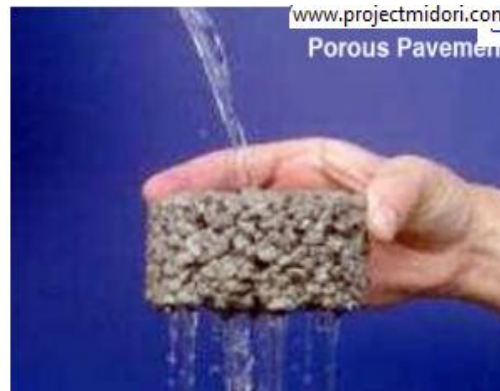
Figura 1-3: Mezcla porosa y /o drenante
