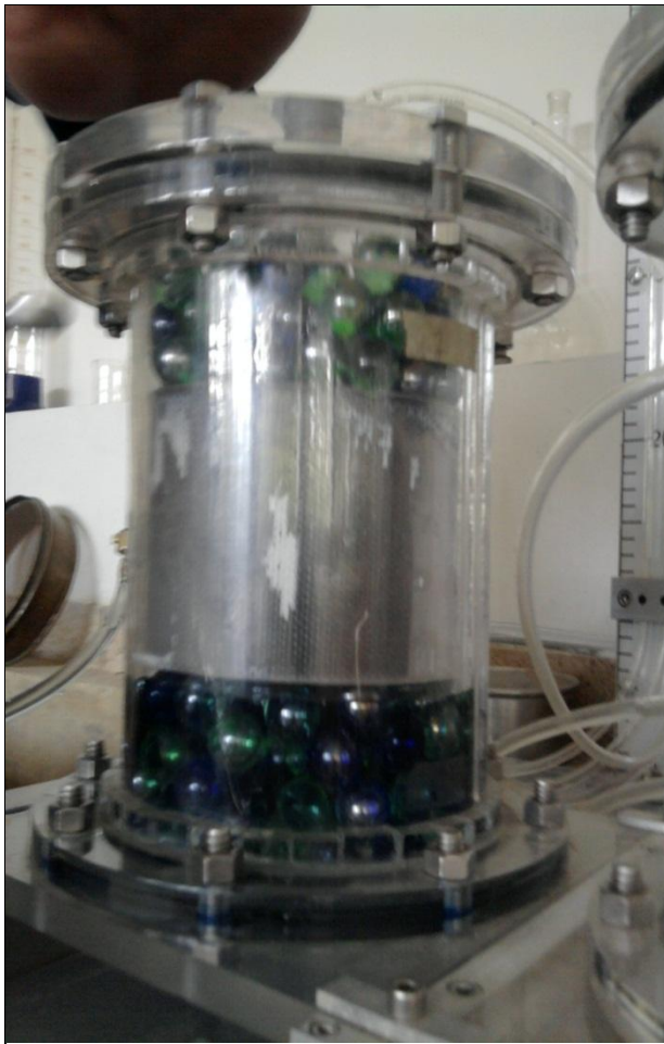
Figura 3-8: Primeras alternativas de impermeabilización de frontera y montaje del ensayo
