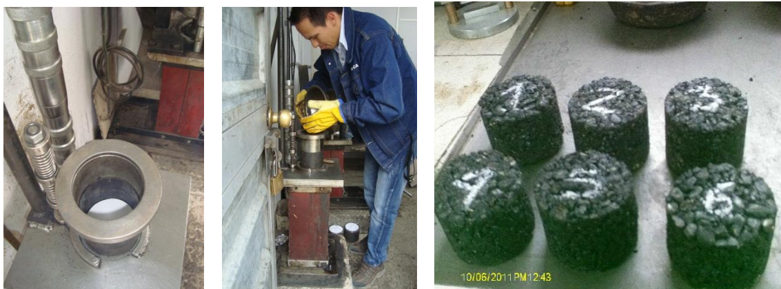
Figura 2-4: Probeta tipo Marshall.
