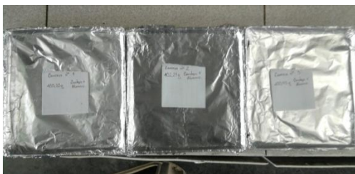
Figura 3-4. Pesaje de mezcla en cada una de las cajas a ensayar. Bandejas metálicas más papel aluminio.
