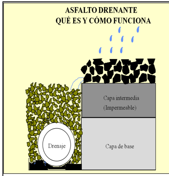
Figura 1-1: Asfalto drenante. Typical OGFC (Tan et al 1997).
