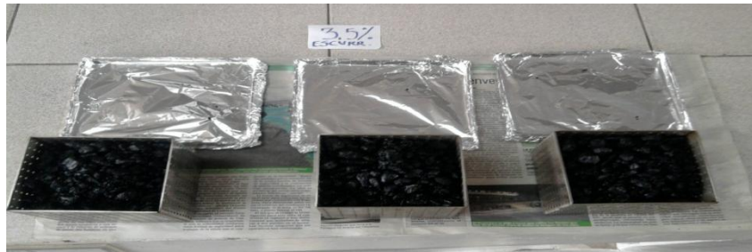
Figura 3-5. Mezcla asfáltica en el horno
