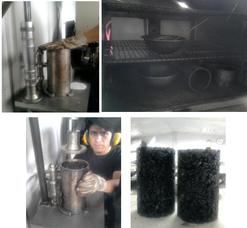
Figura 2-5: Probeta para módulo dinámico.
