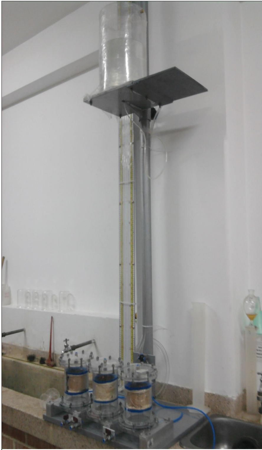
Figura 3-9: Procedimiento final montaje de permeabilidad.
