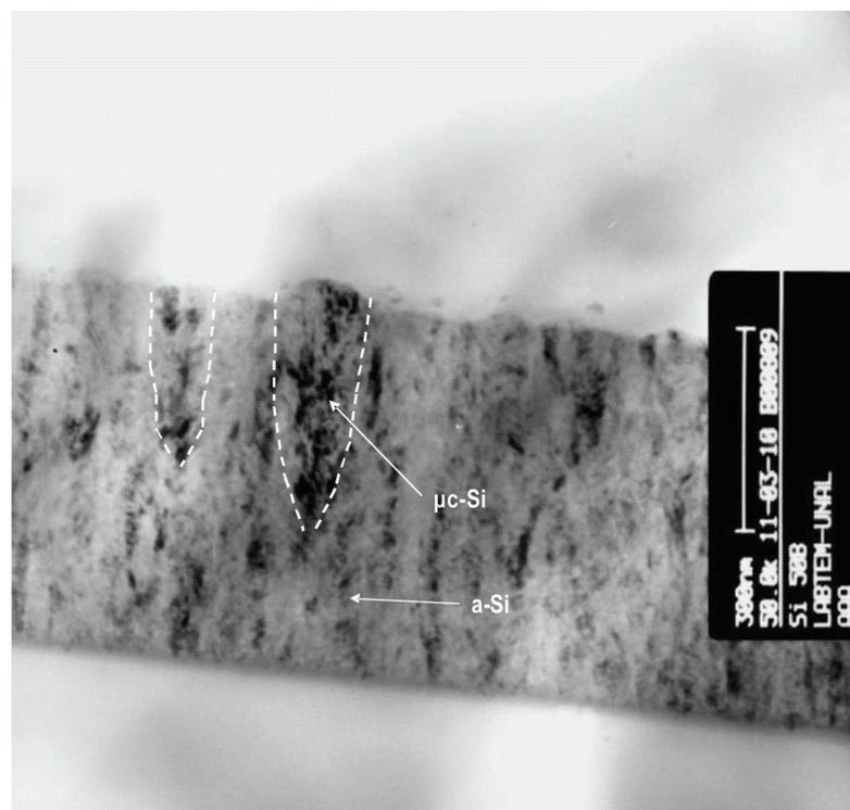
**Figura 4.10.** Micrografía TEM de sección transversal para la muestra de  $\mu\text{-Si:H}$  (50 ppm) evidenciando el crecimiento columnar de los granos microcristalinos.
