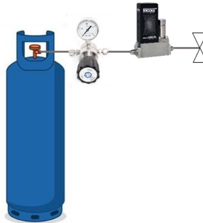
Figura 2-3: Esquema del sistema de inyección de gas.
