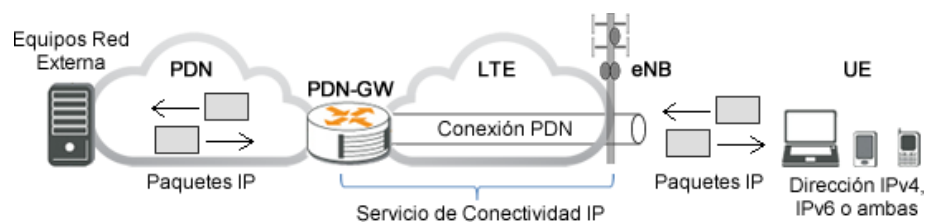
Figura 2-16: Conexión PDN. Adaptación [86]
