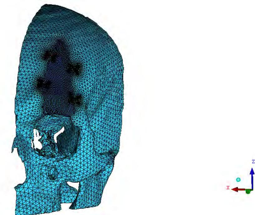
**Figura 3-22.:** Mallado del implante, cráneo y fijación
