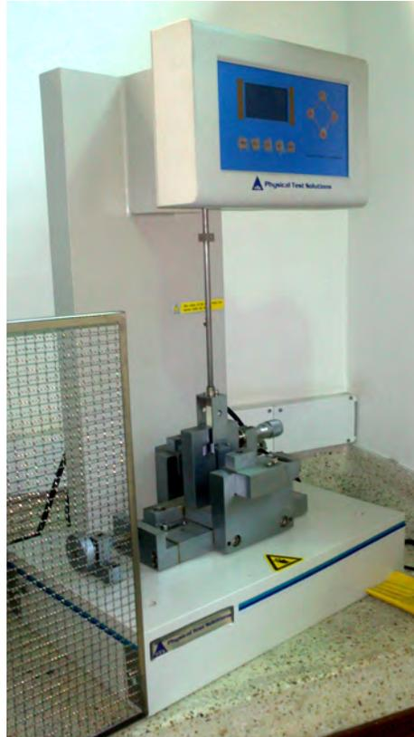
**Figura 3-10.:** Montaje ensayo de impacto
