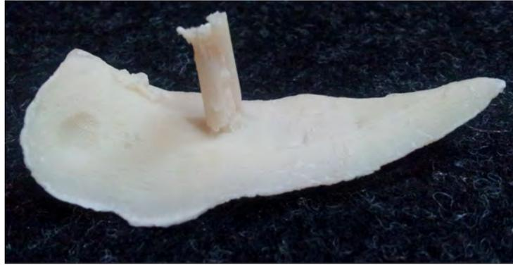
**Figura 3-29.:** Material sobrante después del desmolde
