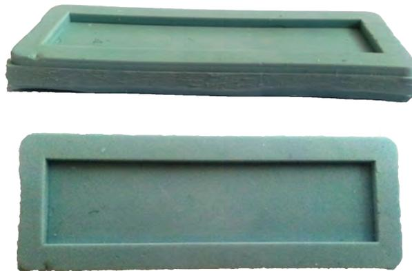
**Figura 3-7.:** Molde de la probeta para el ensayo de flexión
