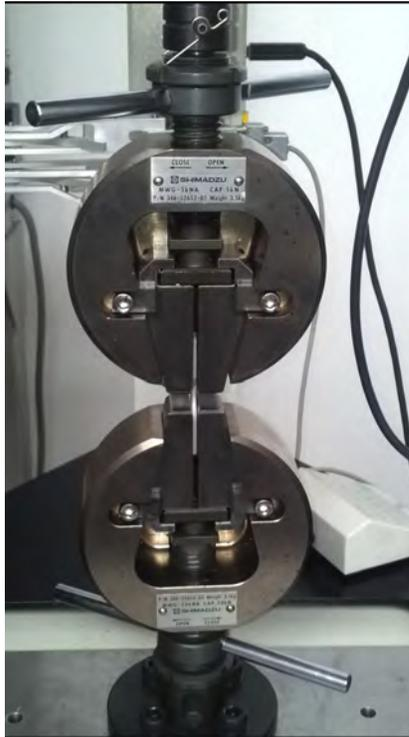
**Figura 3-5.:** Montaje ensayo de tensión
