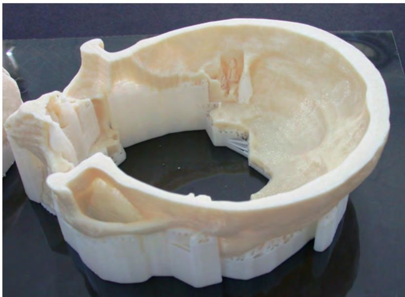
**Figura 3-27.:** Prototipo de la parte inferior del cráneo con la estructura de soporte
