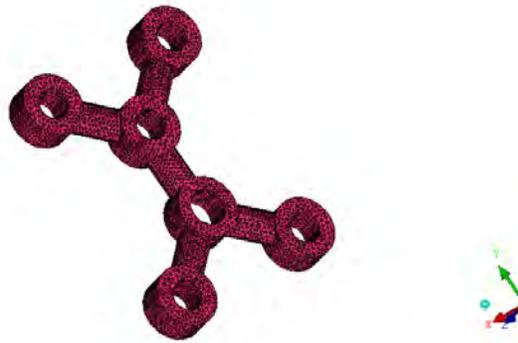
**Figura 3-20.:** Mallado elementos de fijación
