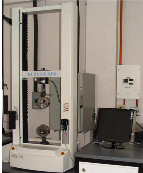
**Figura 3-2.:** Máquina Universal de Ensayos Mecánicos
