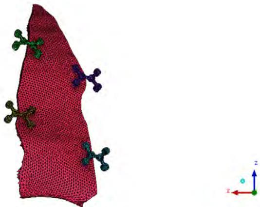
**Figura 3-21.:** Mallado implante y elementos de fijación
