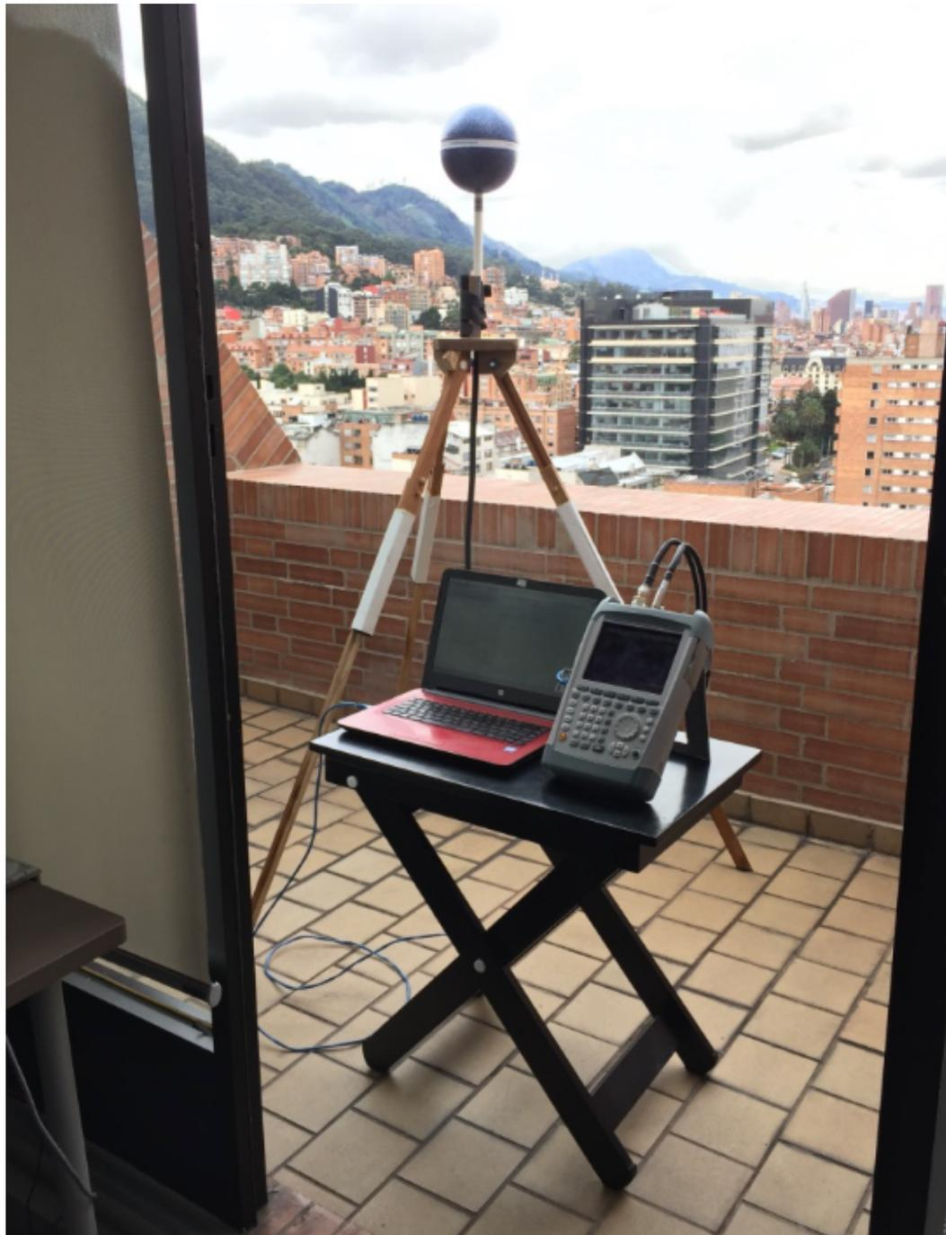
**Figura 4-13.:** Montaje para Medición de Radiaciones No Ionizantes
