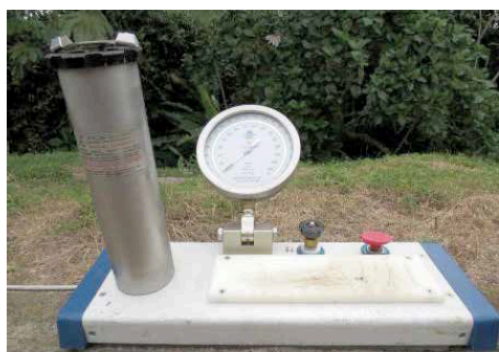
Figura 5. Izquierda: Cámara de Schölander usada para determinar el potencial hídrico foliar. Derecha: Detalle de la parte del peciolo que sobresale de la cámara hermética, en donde se observa la gota de agua, y que indica a través de la lectura en el manómetro, la presión a la cual el agua se mueve al interior de los tejidos.
