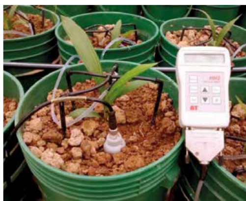
Figura 3. Superior: Plántulas en evaluación por su respuesta al déficit hídrico en casa de mallas. Inferior: Suministro de agua por goteo, sensor y medidor manual HH2. Los sensores de humedad deben permanecer enterrados.
