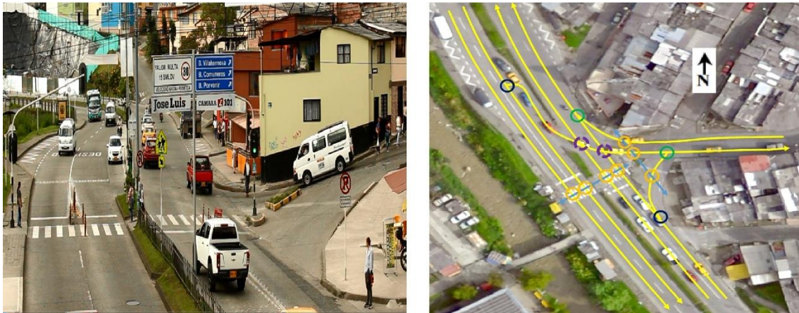
Figura 28 Intersección vial 1 (a). Conflictos intersección vial 1 (b).
