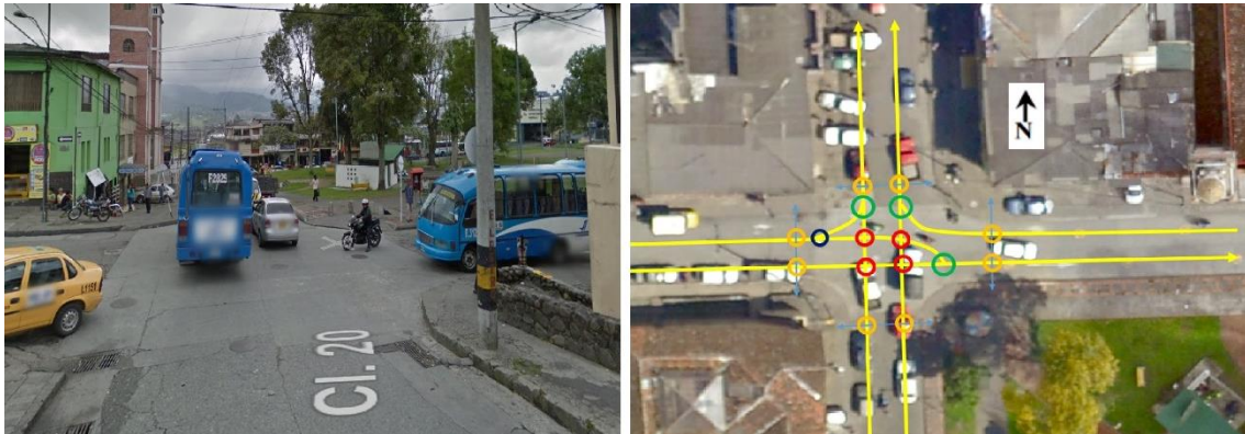
Figura 36 Intersección vial 5 (a). Conflictos intersección vial 5 (b).
