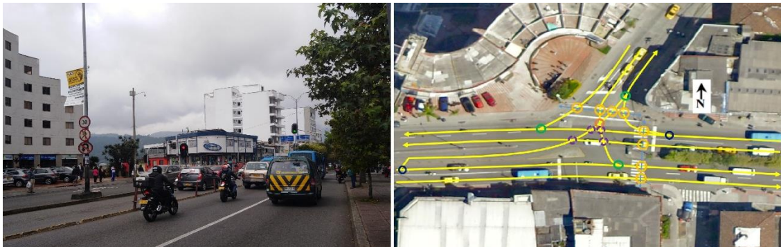
Figura 58 Intersección vial 16 (a). Conflictos intersección vial 16 (b).
