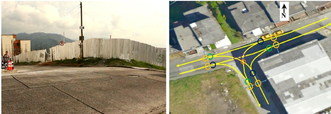
Figura 38 Intersección vial 6 (a). Conflictos intersección vial 6 (b).
