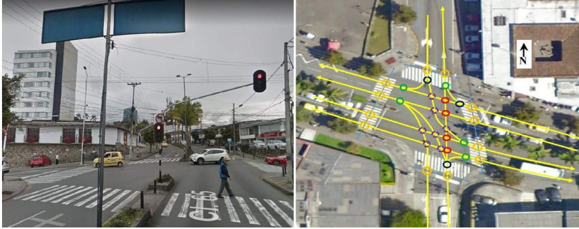
Figura 48 Intersección vial 11 (a). Conflictos intersección vial 11 (b).
