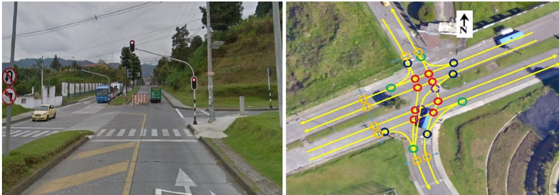
Figura 40 Intersección vial 7 (a). Conflictos intersección vial 7 (b).
