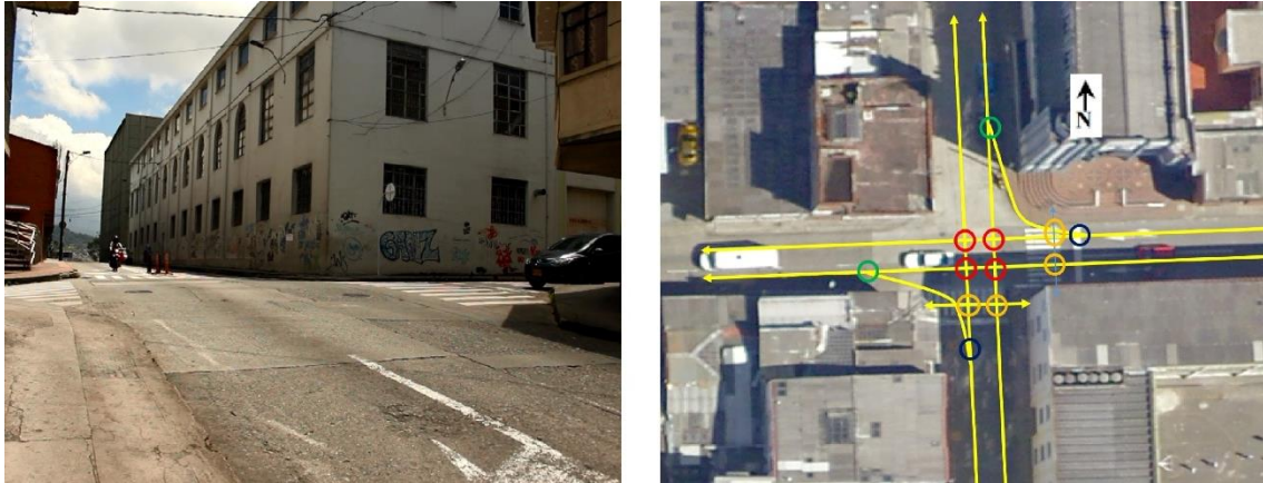
Figura 30 Intersección vial 2 (a). Conflictos intersección vial 2 (b).
