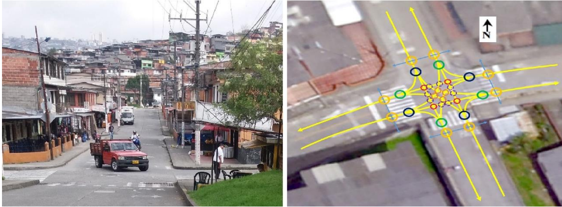
Figura 50 Intersección vial 12 (a). Conflictos intersección vial 12 (b).
