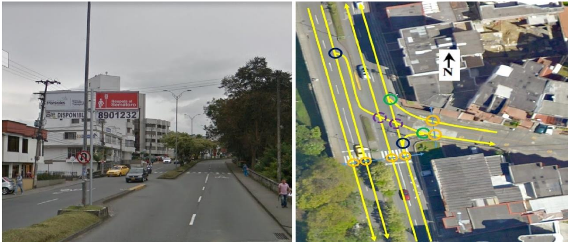
Figura 54 Intersección vial 14 (a). Conflictos intersección vial 14 (b).
