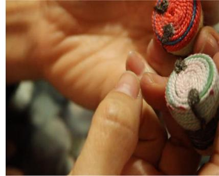
Fotografía 25 Detalle sobre los puntos de hilo conductor pegado en los sellos.
