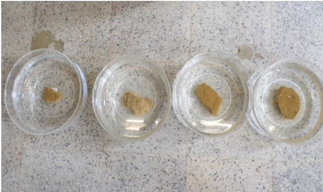
Fotografía 8. Ensayo de potencial de desintegración. Muestras de la areniscas sumergidas en agua después de una semana.
