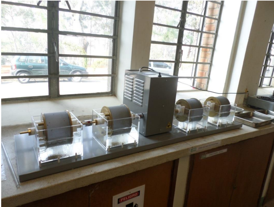
Fotografía 7. Ensayo de desleimiento.
