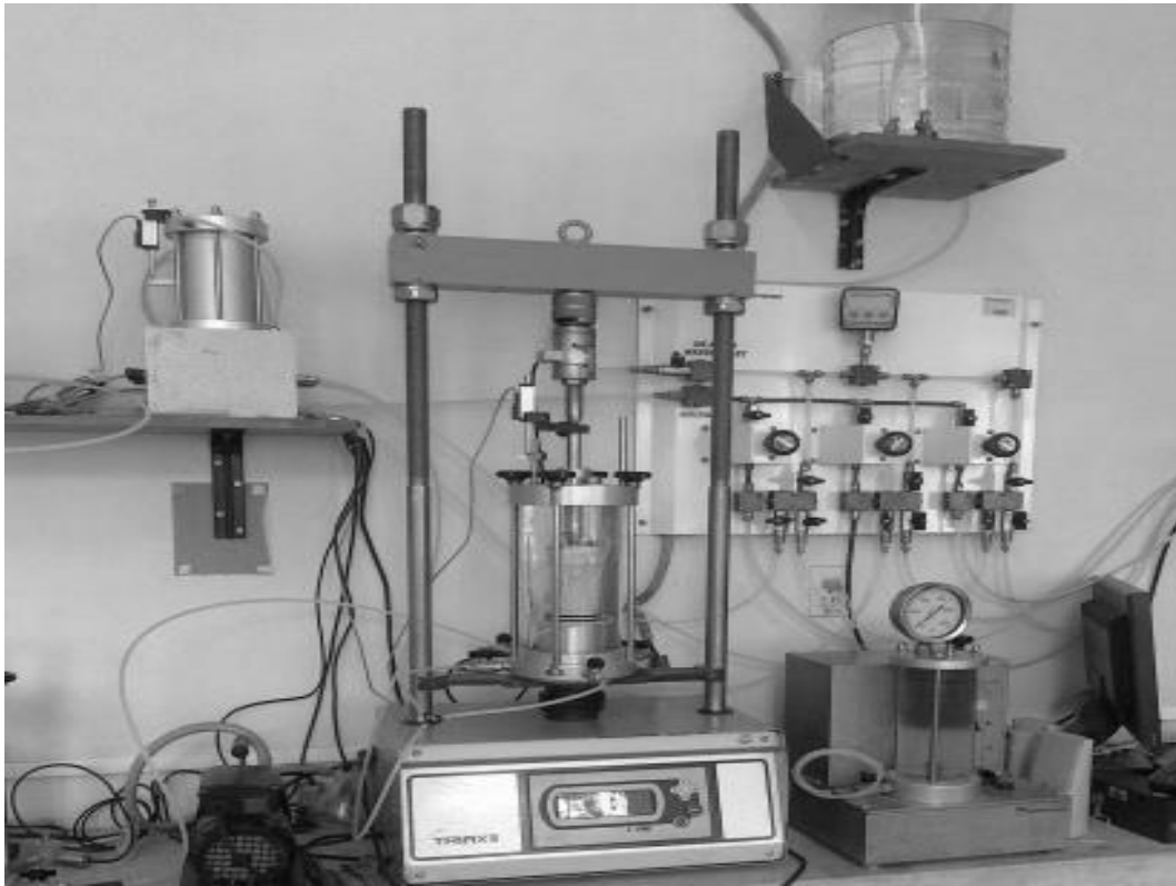
Fotografía 10. Ensayo triaxial axisimétrico a compresión. Durante la ejecución del ensayo.
