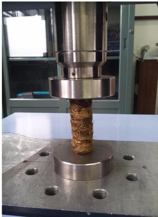
Figura 2-7. Ensayo de resistencia a la compresión. Fuente: Autor.
