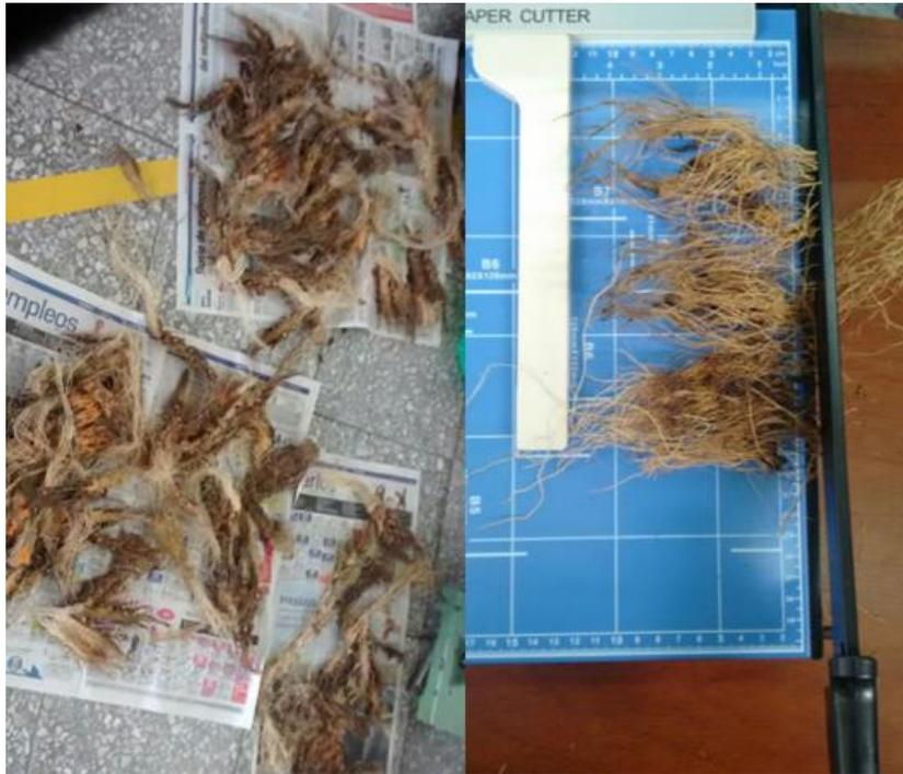
Figura 2-3. Separación, secado y corte de fibras de tusa. Fuente: Autor.
