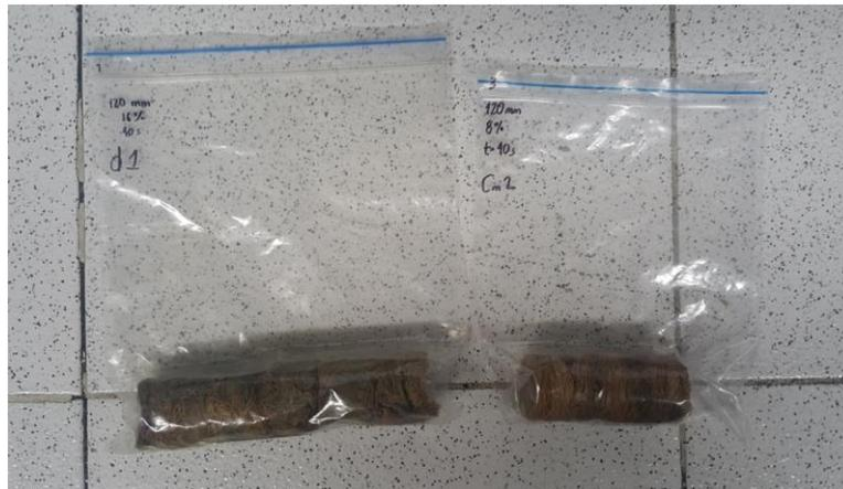
Figura 2-1. Codificación de factores de clasificación y briquetas fabricadas para contenidos de humedad de 16% b.h. y 8% b.h. Fuente: Autor.
