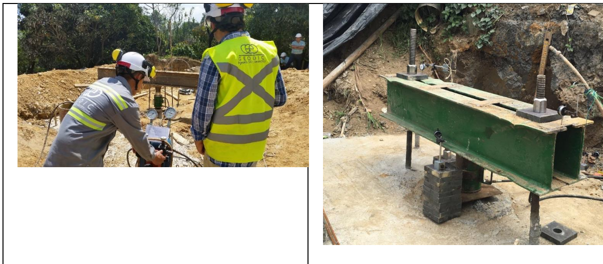
Figura 10. Diferentes montajes pruebas de carga locales
