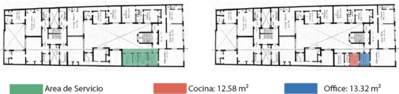
Imagen 95. Pisos 2º y 3º Piso – Edificio para Esteban Jaramillo – José M. Martínez Cárdenas 1945– Cocina y office Fuente: Archivo de Trujillo, Martínez, Cárdenas. S.F. - ADB
