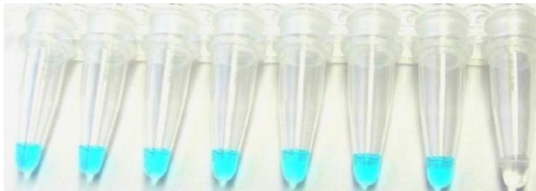
Figura 19. Detección de LAMP por cambio de color con verde de malaquita.
