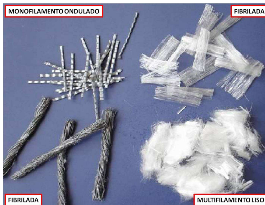
Figura 1. Tipos de fibras de polipropileno: monofilamento, multifilamento y fibrilada [THE ABERDEEN GROUP 1983].
