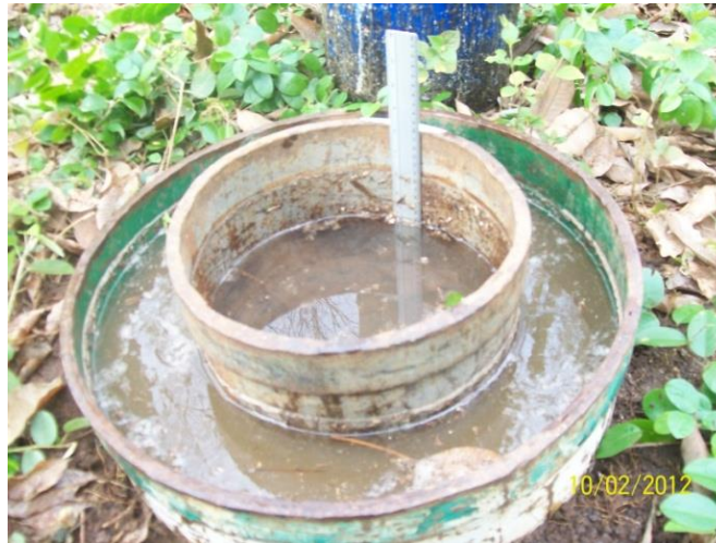
Figura 2-3: Prueba de infiltración
