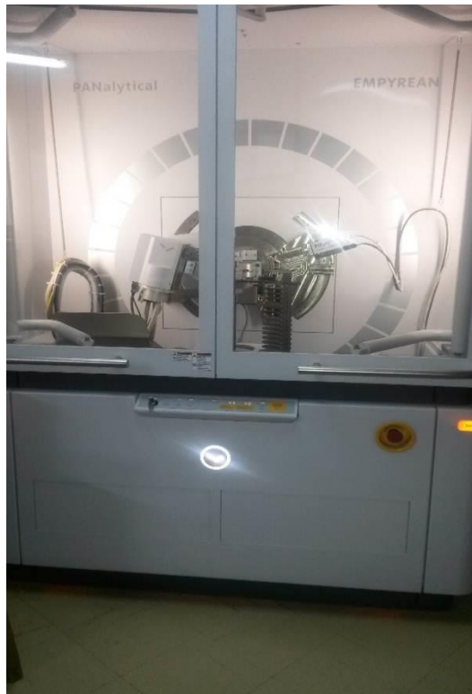
Figura 2-8: Equipo Difracción de rayos x
