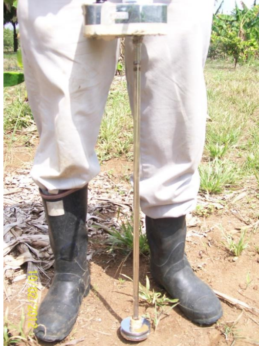
Figura 2-4: Medición resistencia a la penetración
