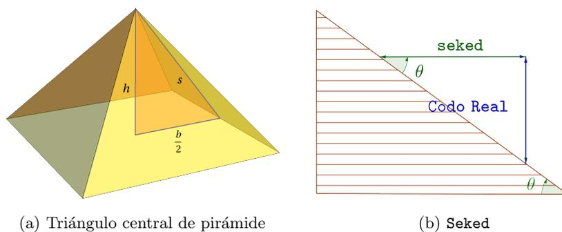
Figura 3: Triángulo central de pirámide y seked.
