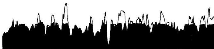
Figura 15. Comparación de un perfil antes y después del desgaste (Buckley, 1981)
