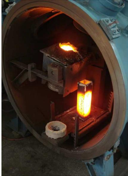
Fotografía 1: Metal fundido dentro del molde, a su lado izquierdo se puede observar la mazarota.
