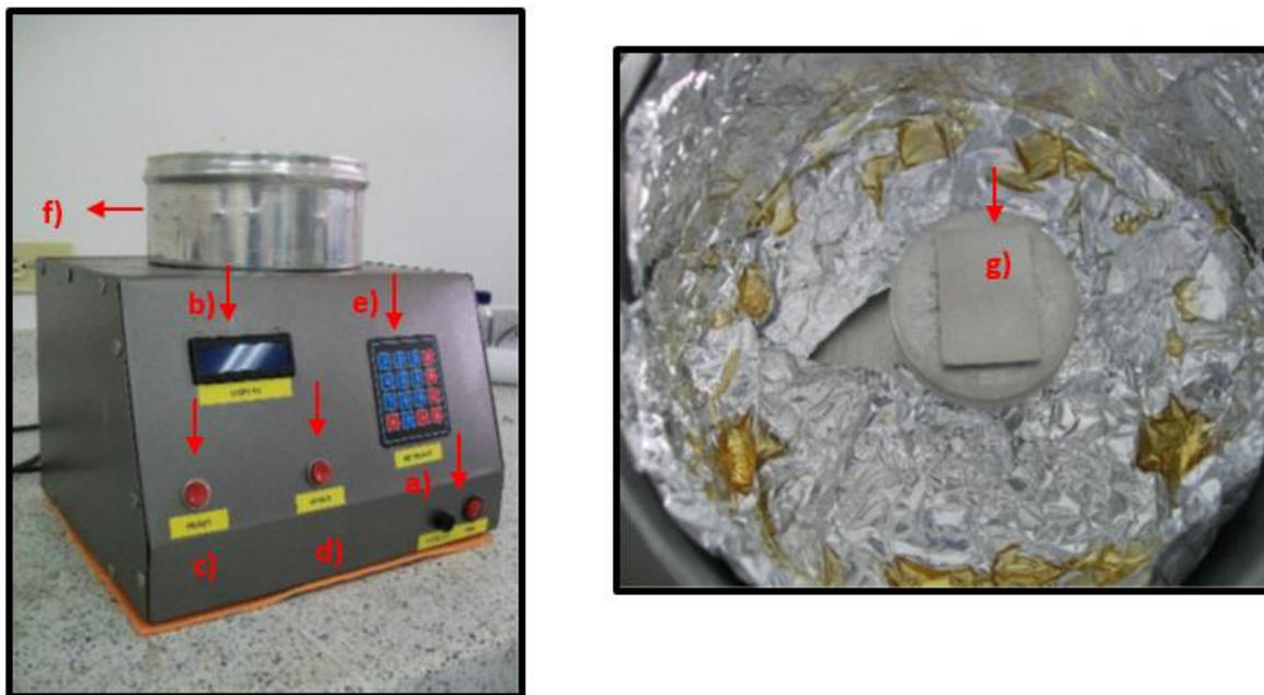
Figura 2-3: Spin-Coater. a) Encendido on-off b) Pantalla de control. c) Restaurar. d) Arranque. e) Teclado de control. f) Cámara de depósito. g) Porta-sustrato.
