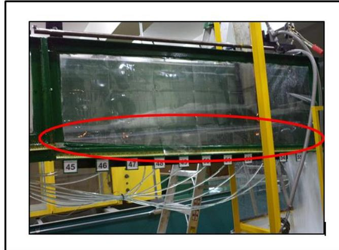
Figura 4-8: Fondo en acrílico para creación de pendiente horizontal.
