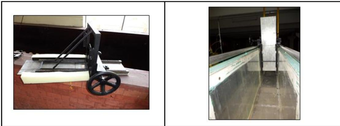
**Figura 4-2: Compuerta tipo guillotina para control del flujo aguas abajo del canal.**
