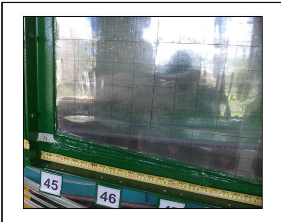
**Figura 4-10: Cuadrícula en paredes del canal.**
