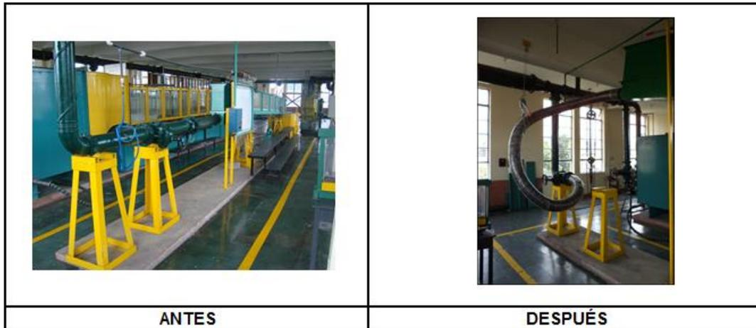
Figura 4-5: Manguera de alimentación de agua al canal.
