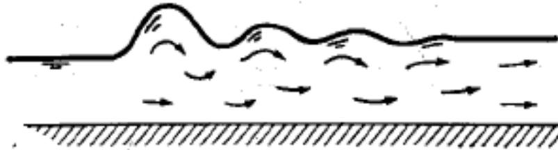
Figura 2-8: Resalto ondulante (Tomada de Ven Te Chow, 1959).
