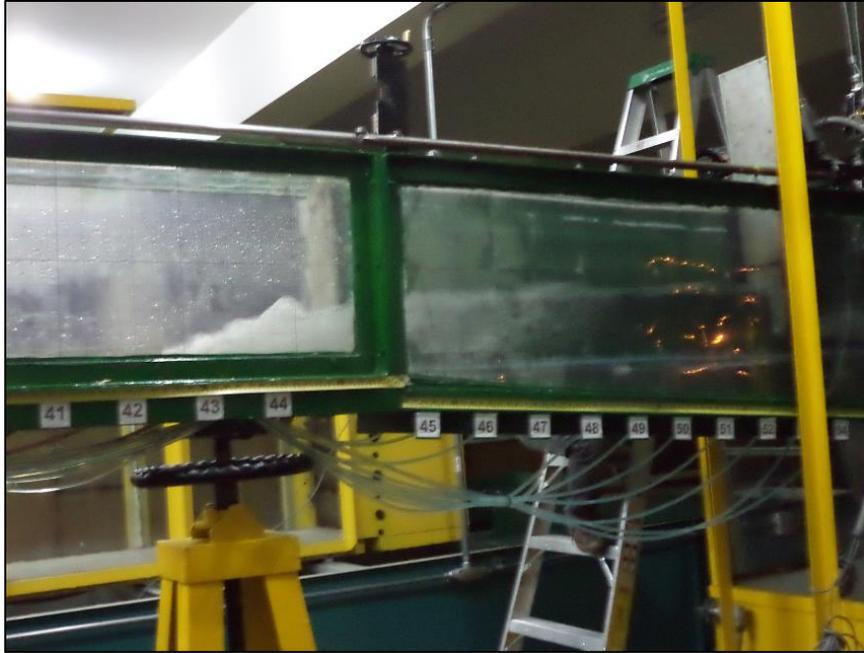
Figura 4-14: Resalto hidráulico tipo C.
