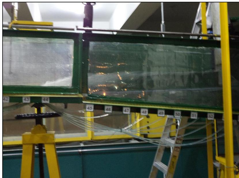
**Figura 4-13. Resalto hidráulico tipo B.**
