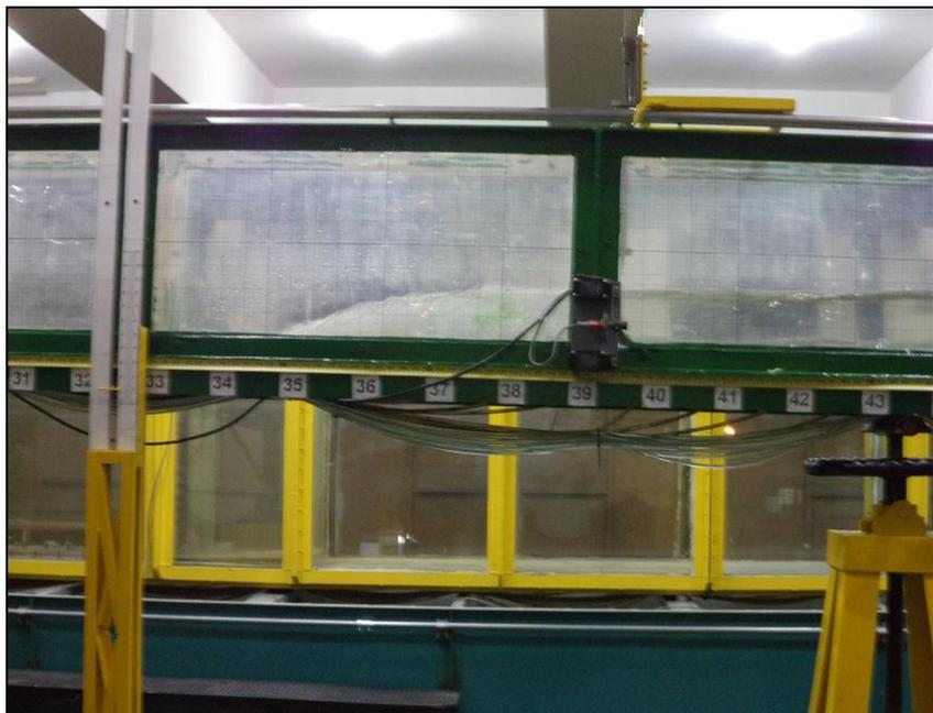
Figura 4-15. Resalto hidráulico tipo D-E.
