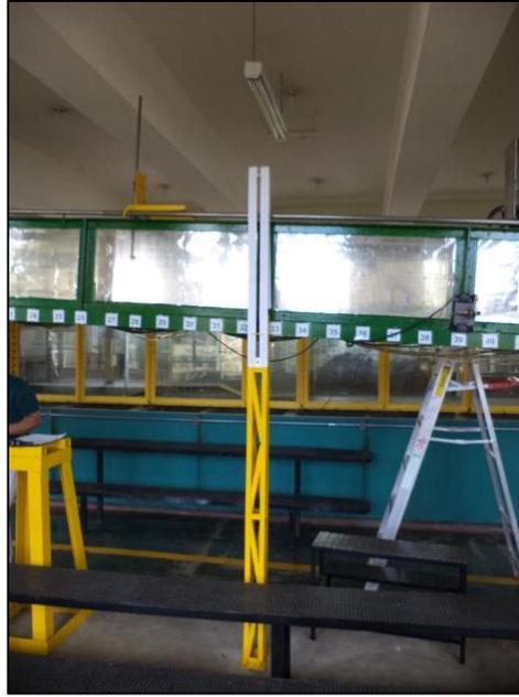
Figura 4-18: Regleta para medición de la inclinación del canal.
