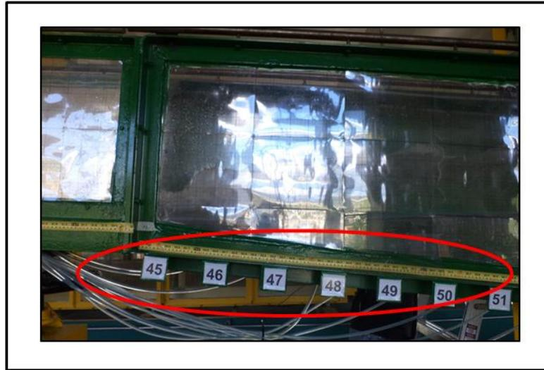
**Figura 4-9: Ubicación y marcación de piezómetros**
