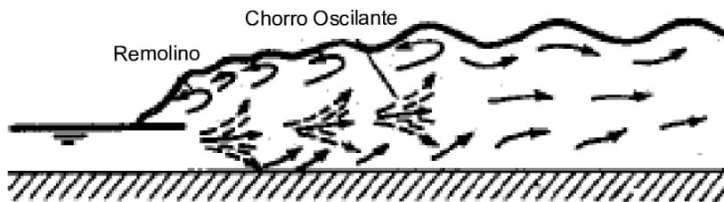
Figura 2-10: Resalto ondulante (Tomada de Ven Te Chow, 1959).
