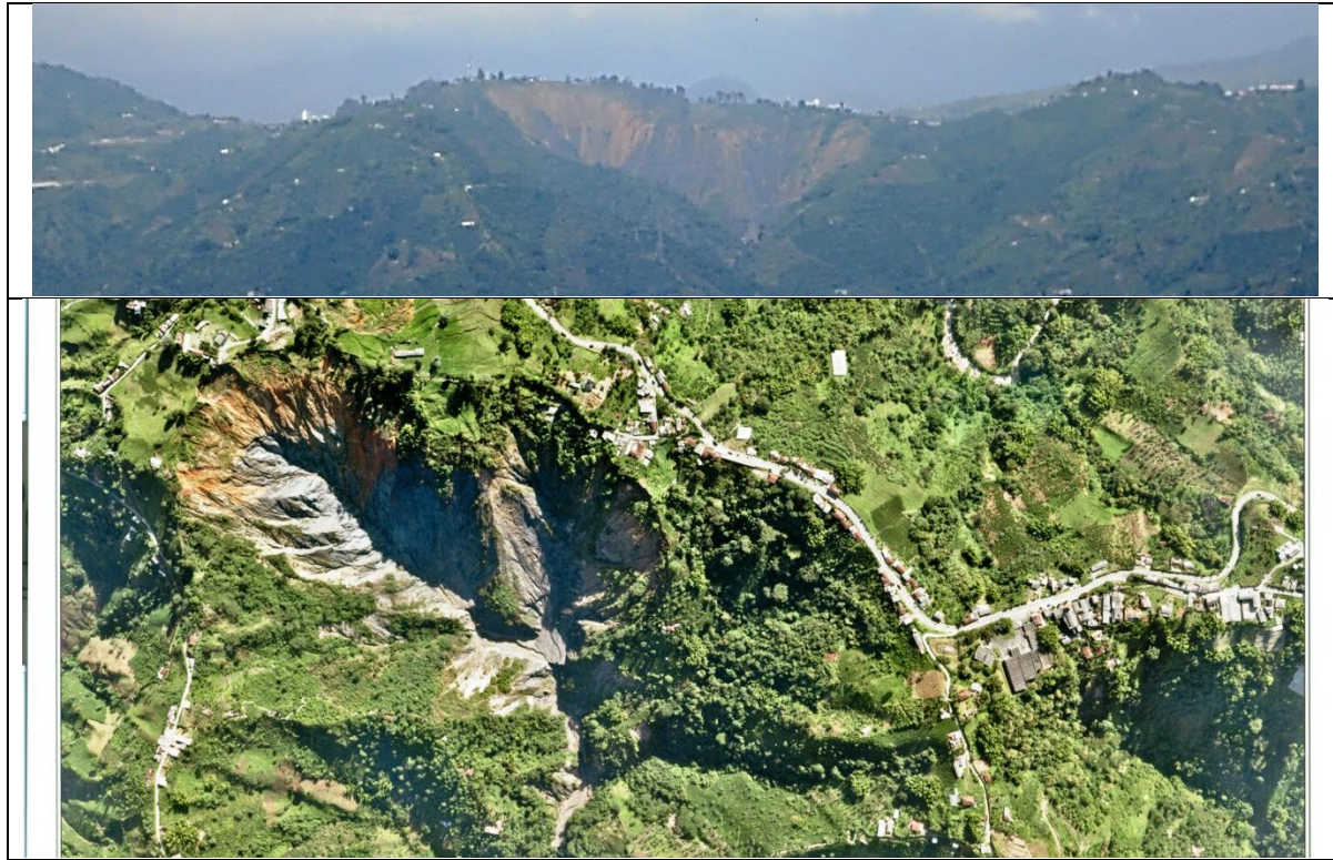
Figura 3. Cárcava del Tablazo (vistas horizontal y aérea) desde la cota media hacia abajo con tonalidad gris corresponde a afloramiento de esquistos grafitosos del Complejo Quebradagrande, lo suprayacen depósitos de flujos de lodo de la Formación Casabianca en tono rojizo y en el extremo superior derecho en tono habano café claro depósitos de Caída Piroclástica.
