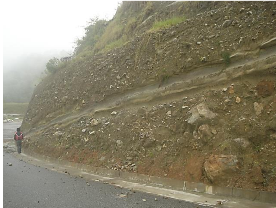
Figura 10. Depósitos de flujos de lodo interestratificados con una capa de grawaca con buzamiento hacia el noreste por tectonismo.
