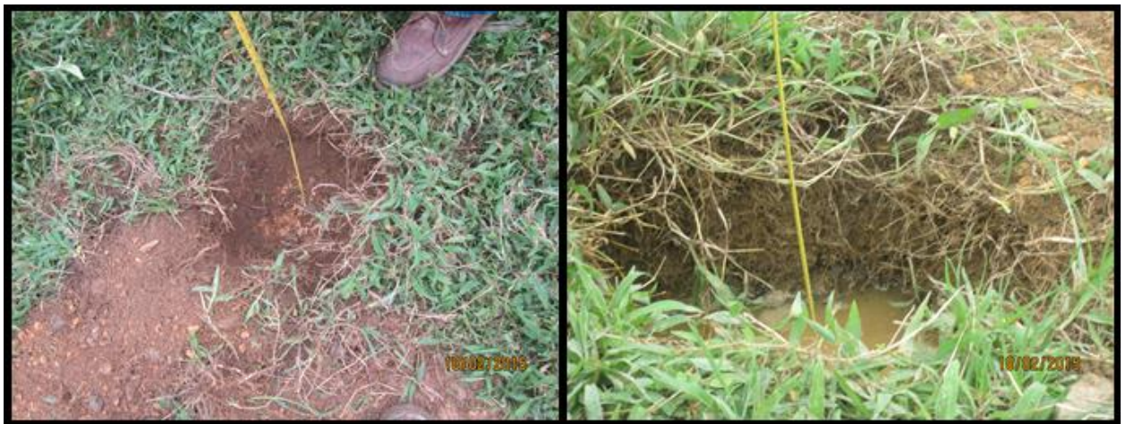
Figura 4 - 12 Ensayo de permeabilidad in situ. (JAM Ingeniería y medio ambiente S.A.S, 2015)
