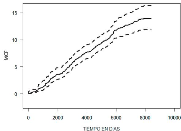
FIGURA 4: MCF estimada en SPLIDA para los interruptores FL245 por baja presión de aceite con intervalos de confianza del 95 %.
