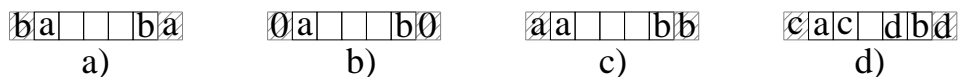
Figura 1-3. Posibles condiciones de frontera en la configuración de un autómata celular. a) Periódica, b) Fija 1, c) Adiabática, d) Reflectiva. Las celdas sombreadas son virtuales.
