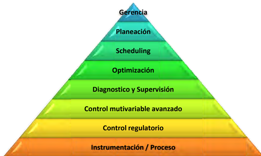
Figura 1.3 Esquema del control jerárquico global en una planta Industrial (Zhu 2001)
