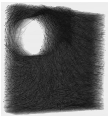
Figura 3. Tomografía de espécimen de UHPRFC en la zona de conexión. (Fuente propia. Imagen elaborada en el tomógrafo de la Universidad KTH en Suiza).
