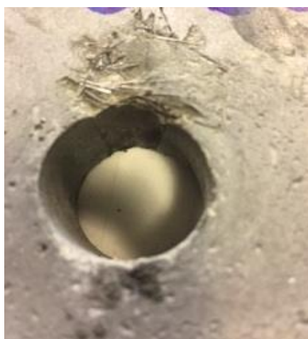
Figura 4. Falla por aplastamiento de un elemento de UHPFRC (Fuente propia)
