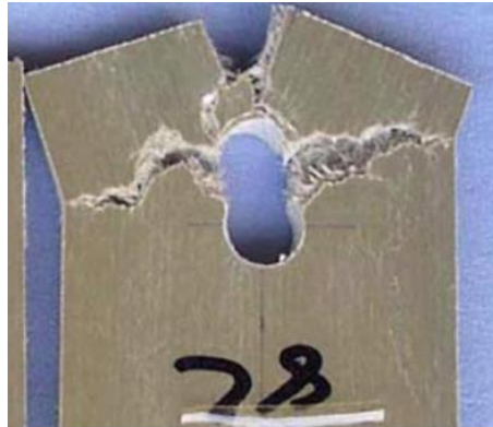
Figura 7. Falla segmentada en conexión en un elemento de GRC (Glass Reinforced Concrete). (Fuente (Camacho E, 2013)).
