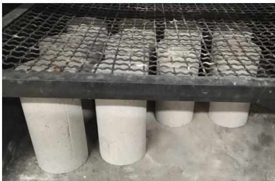
II. 18a. Secado de cilindros a 80°C (24h)
