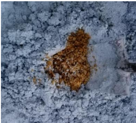
II. 16a. Incorporación de la fibra a la mezcla
