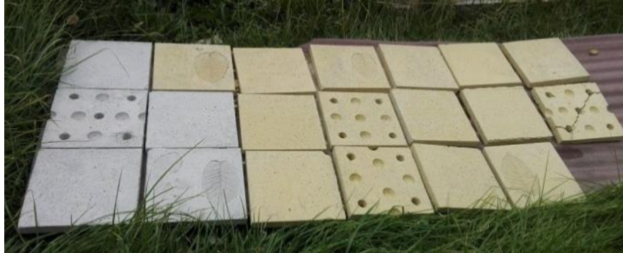
Ilustración 14: Colocación de placas a la intemperie, parte trasera patio SINDU (autoría propia)
