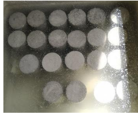
II. 17b. Curado Cilindros en piscina (28días).
