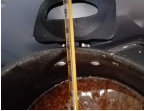
II. 12a: Mineralización aceite de linaza 5min 80°C – 5min 24° (Proceso 3 veces)
