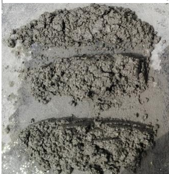
II. 3a. División dela mezcla en 3 partes
