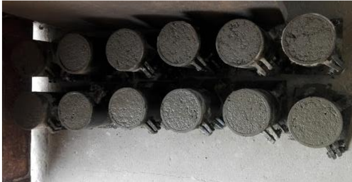
II. 17a. Cilindros en formaleta (24h).
