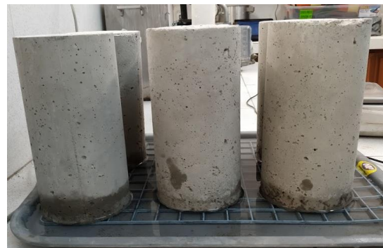
II. 18b. Ensayo de sortividad intervalos de tiempo
