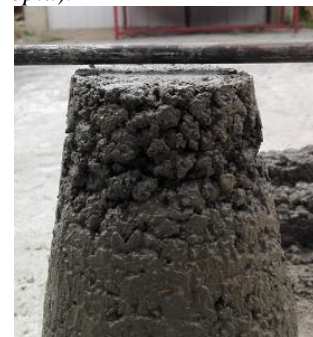
II. 3c. Medición del asentamiento
