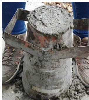
Ilustración 15: Ensayo de asentamiento (autoría propia).
