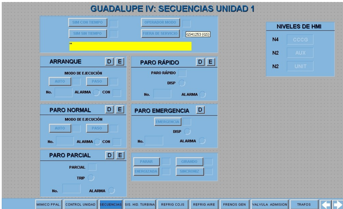
Figura 5. Pantalla de operación de la máquina en el Digivis
