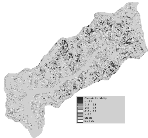
Figura 7. Cuenca sometida al modelo SHALSTAB con cohesión de 240 Kgf/cm 2 , ángulo de fricción interna de 40 grados y una precipitación desconocida.
