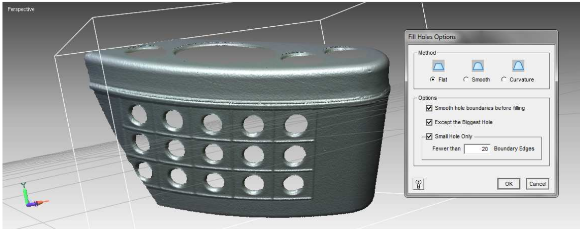
Figura 19. Parámetros estándar para el llenado de huecos. Imagen tomada mediante el software RapidForm®.
