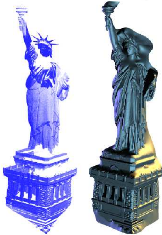
Figura 14. Ajuste de superficies de una vista parcial de un modelo de la estatua de la libertad. A la izquierda, los puntos adquiridos. A la derecha el ajuste de una superficie de base radial. Nótese como todos los huecos son corregidos aunque en algunos casos la representación final no sea adecuada. Imagen extraída de [22].
