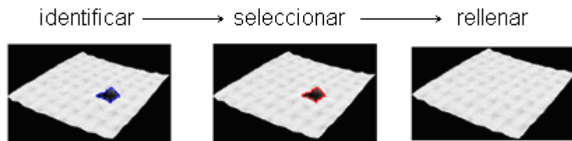
Figura 11. Pasos para la corrección de huecos en superficies.
