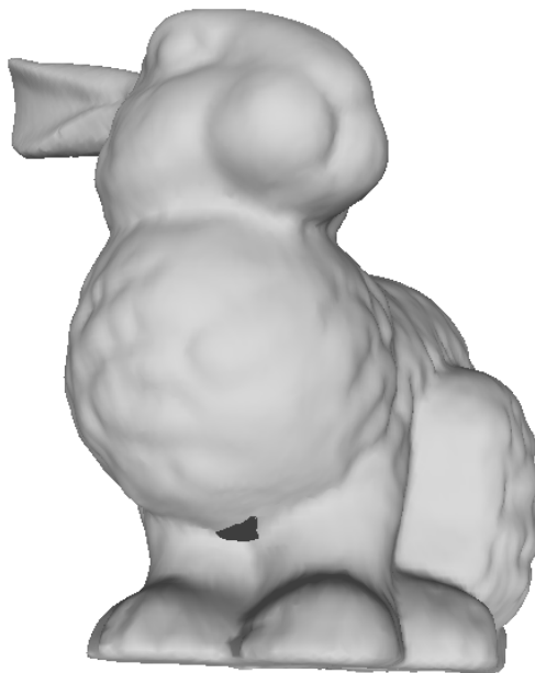
Figura 17. Hueco generado por auto-oclusión de la superficie.
