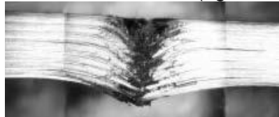
Figura 28. Micrografía transversal de la delaminación en un sistema laminado de 6,15 mm de espesor modelo CFRP penetrado por un proyectil metálico (Sanders 1997) [56]
