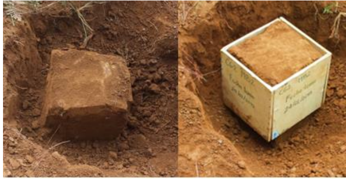
Figura 38 Toma de muestra inalterada, Cajón 3-suelo residual de Dunita
