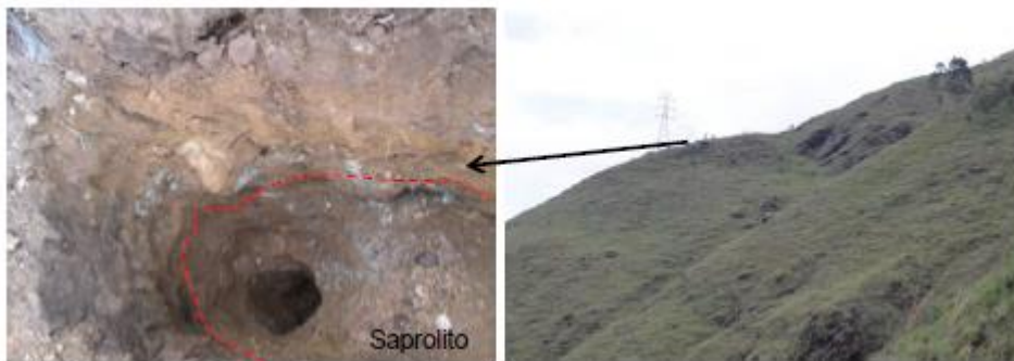
Figura 11. Suelo limo-arenosa de saprolito ubicado en lomo sector norte del área de estudio. Tomado (DEACIVIL SAS, 2013)
