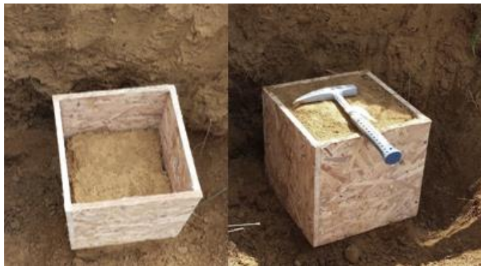
Figura 40 Toma de muestra inalterada, Cajón 5-depósito de vertiente.
