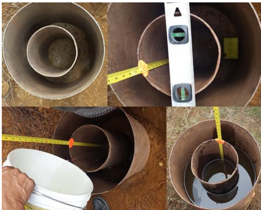
Figura 41 Ensayo de infiltración con anillo doble
