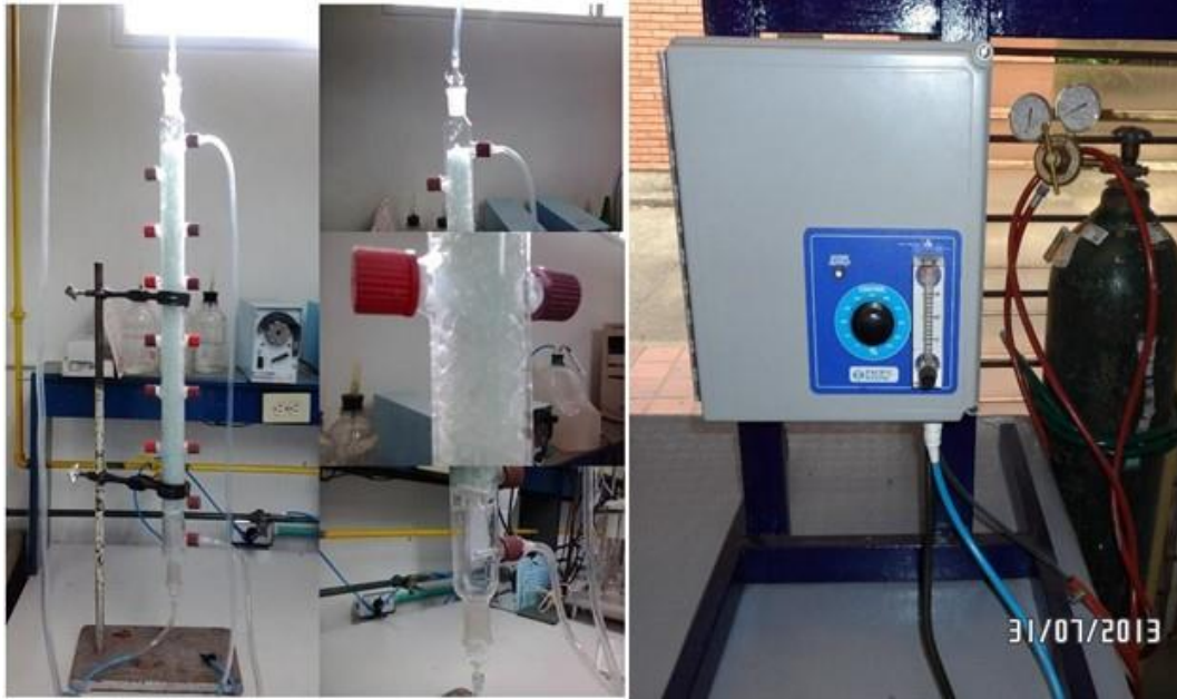
Figura 6-2. Montaje experimental para las pruebas con ozono: a) columna empacada y b) generador de ozono.
