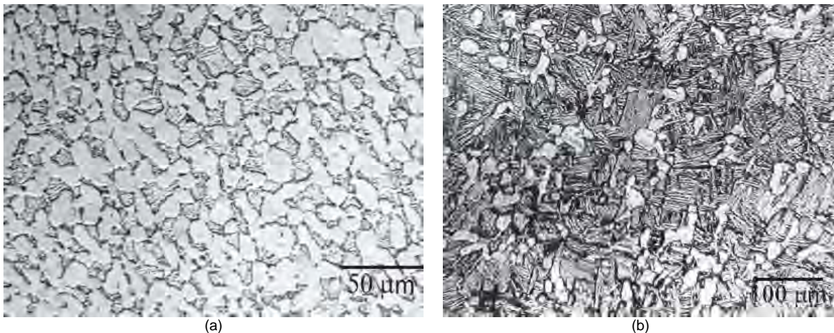
Figura 2.7 Microestructura (a) mill-annealed y (b) duplex del Ti6Al4V [1].
