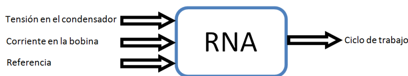
Figura 3-5: RNA con tres entradas y una salida
